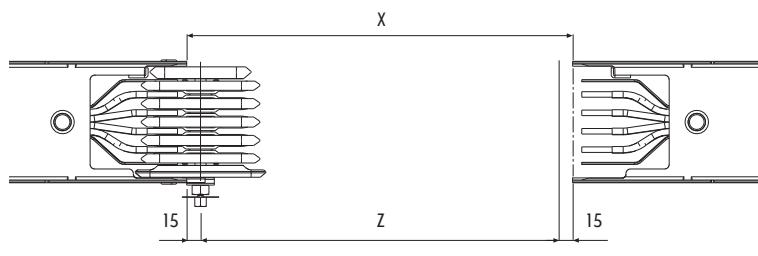
A dimensão nominal "Z" do elemento reto especial que se deseja solicitar é obtida subtraindo 30mm da dimensão "X" medida. Por exemplo: dim. X = 1480mm - 30mm = 1450mm dim. "Z"
