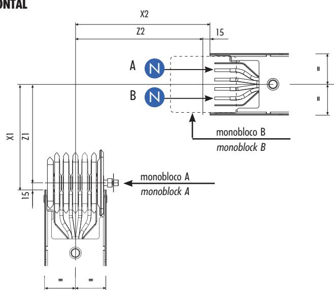
As dimensões nominais "Z1" e "Z2" do cotovelo horizontal especial que se deseja solicitar são obtidas subtraindo 15mm das dimensões "X1" e "X2" medidas. Devem-se indicar as posições do Monobloco (A ou B) e do neutro (A ou B).
