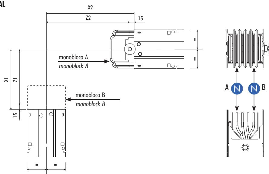
As dimensões nominais "Z1" e "Z2" do cotovelo vertical especial que se deseja solicitar são obtidas subtraindo 15mm das dimensões "X1" e "X2" medidas.
