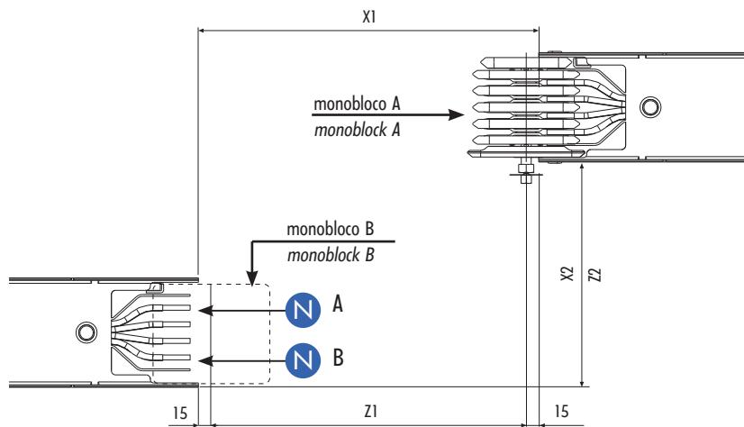
A dimensão nominal para realizar o pedido de uma unidade Zé horizontal especial é obtida subtraindo 30mm da dimensão "X1" medida. A dimensão "X2" é a nominal. Deve indicar as posições do monobloco (A ou B) e do neutro (A ou B).
