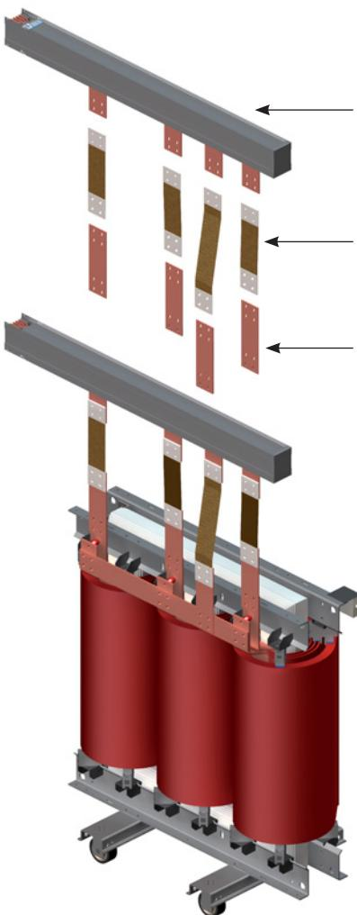
(\*) Se a distância entre as saídas do sistema de linhas elétricas pré-fabricadas e as do transformador excedem os 300/350mm, é necessário instalar a extensão TR (para maiores informações, entre em contato com nossa área técnica).
