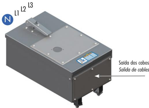
É utilizada para extraír corrente dos elementos retos do sistema de linhas elétricas pré-fabricadas. Este modelo de caixa de derivação está preparado para receber disjuntores automáticos de caixa moldada (MCCB) como TMAX (ABB SACE), NS (SCHNEIDER ELECTRIC) ou DPX (LEGRAND). A pré-instalação prevé a inserção de disjuntores fixos com terminais frontais, equipados com chave de acionamento rotativo.
