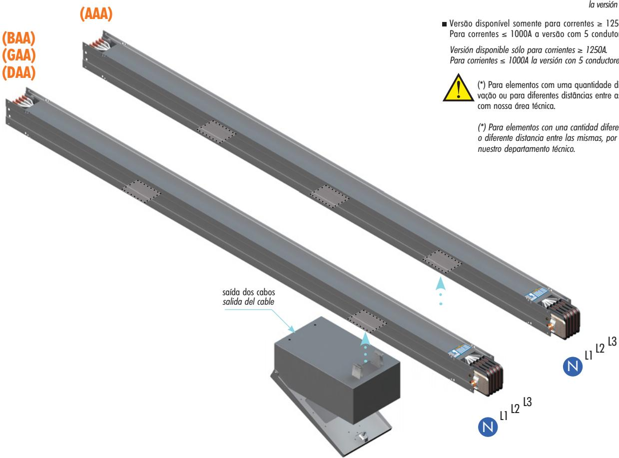
Los elementos rectos de distribución con salidas hacia un lado son utilizados para la distribución de energía mediante el uso de cajas de distribución que se pueden conectar sin necesidad de cortar el suministro eléctrico de la línea. Su versión estándar tiene 3 salidas para cajas de derivación sobre un único lado para la versión (AAA) de cuatro polos y 2 salidas para cajas de derivación (siempre sobre un único lado) para las versiones (BAA, GAA, DAA) de 5 polos, a lo largo de sus 3000mm.
