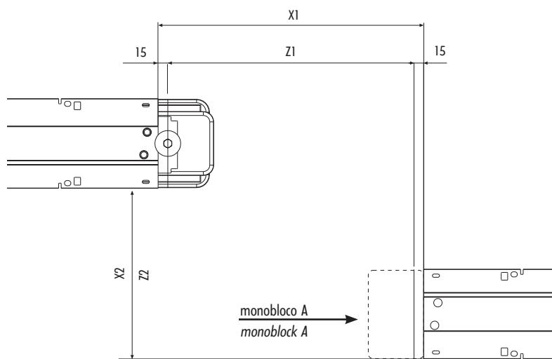
A dimensão nominal para realizar o pedido de uma unidade Zé vertical especial é obtida subtraindo 30mm da dimensão "X1" medida. A dimensão "X2" é a nominal. Deve indicar as posições do monobloco (A ou B) e do neutro (A ou B).
