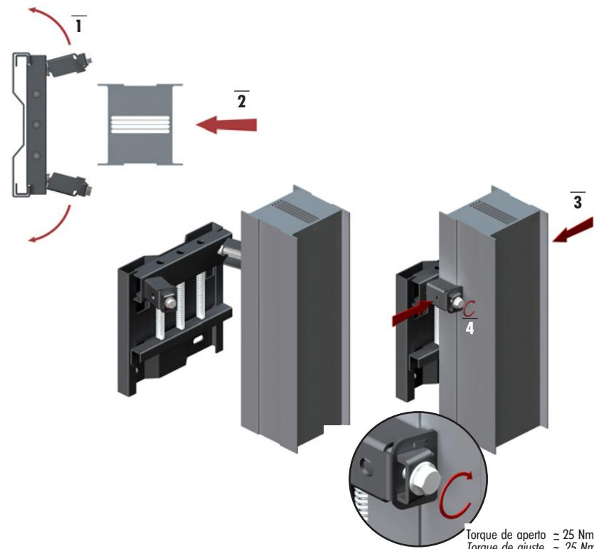
O suporte de fixação por molas é utilizado para sustentar o sistema de linhas elétricas pré-fabricadas (é o dispositivo que sustenta os elementos de canalização), enquanto o suporte para alinhamento vertical é utilizado para manter os elementos alinhados ao longo de seu eixo.
