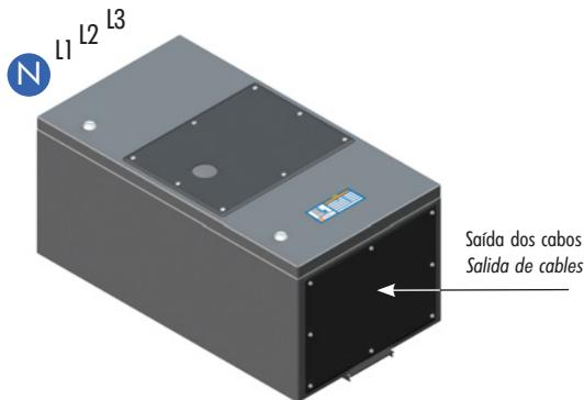
É utilizada para extraír corrente dos elementos retos do sistema de linhas elétricas pré-fabricadas. Este modelo de caixa de derivação está preparado para receber disjuntores automáticos de caixa moldada (MCCB) como TMAX (ABB SACE), NS (SCHNEIDER ELECTRIC) ou DPX (LEGRAND). A pré-instalação prevê a inserção de disjuntores fixos com terminais frontais, equipados com chave de acionamento rotativo.
