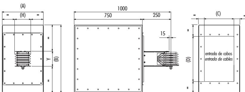
Esse elemento é utilizado para alimentar o sistema de linhas elétricas pré-fabricadas por cabos em grandes percursos verticais. A posição da linha elétrica pré-fabricada com relação ao corpo da caixa, permite a instalação da unidade em paredes e a utilização de abraçadeiras para fixação vertical. (pág. 84)
