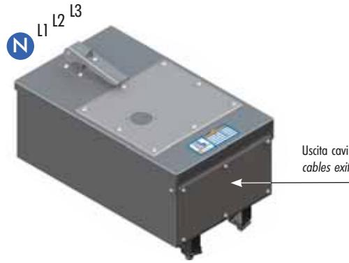
Questa unità è utilizzata per derivare corrente dal condotto sbarre esclusivamente tramite gli elementi rettilinei di distribuzione. È predisposta per l'inserimento di interruttori automatici tipo TMAX (ABB SACE), NS (SCHNEIDER ELECTRIC), DPX (LEGRAND) o RECORD PLUS (GENERAL ELECTRIC). La predisposizione prevede l'inserimento di interruttori fissi con attacchi anteriori, corredati di maniglia rotante rinviate.
